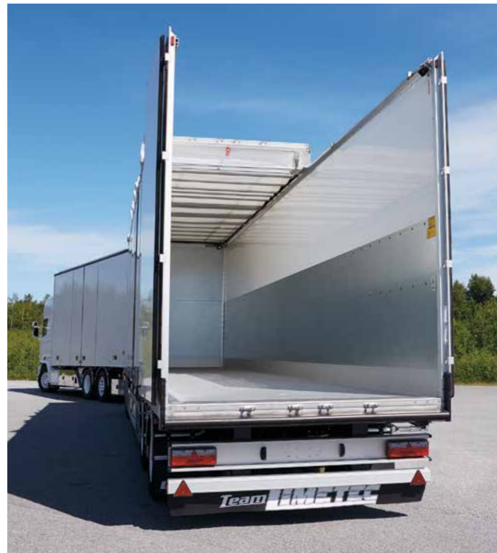
Liukuva katto mahdollistaa kattonosturilla lastaamisen.
