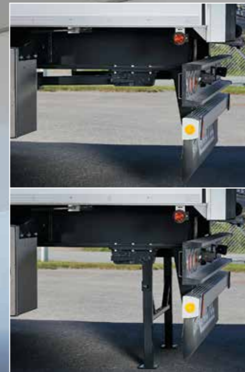
Utfällbar stöd på släp vid lastning med tunga truckar.
