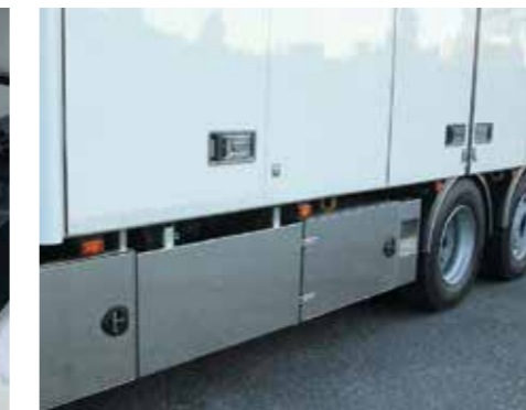
Dörrar utan synliga tätningar.
