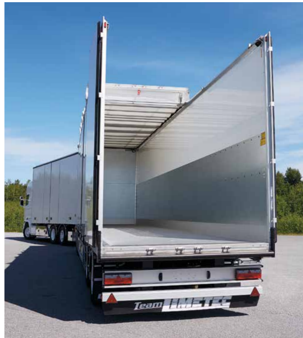
Skjutbar kapelltak möjliggör traverslastning.
